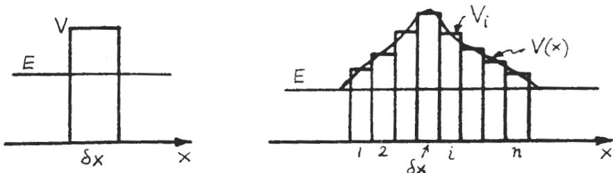
Αν το φράγμα δυναμικού έχει το γενικό σχήμα  $V(x)$ , υποθέτοντας ότι αυτό αποτελείται από  $n$  διαδοχικά τετραγωνικά φράγματα πλάτους  $\delta x$  και ύψους  $V_i$  για  $i = 1, 2, \dots, n$  (βλ. σχήμα), υπολογίστε την πιθανότητα διέλευσης του σωματιδίου μέσα από το φράγμα, Εξ.(3.96).
