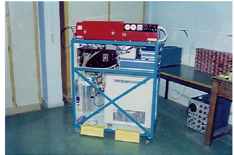
Σύστημα laser λαπαροσκοπικής/ενδοσκοπικής χειρουργικής. Διακρίνονται οι υπομονάδες των lasers (τροφοδοτικά, παλμογεννήτριες, σύστημα παροχής αζώτου, ψυκτικό μηχανήμα, φίλτρο ψυκτικού μηχανήματος κ.λπ.).
