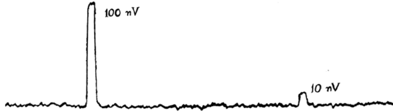
Σχήμα 1.2. Καταγραφή της απόκλισης ενός γαλβανομέτρου, στην οποία φαίνεται ο θερμικός θόρυβος. Για βαθμονόμηση, φαίνονται και οι αποκλίσεις για σήματα ίσα με 100 και 10 nV.
