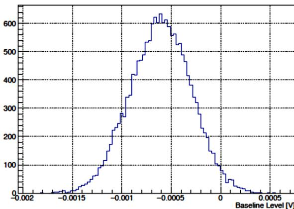
Noise RMS, Anode 650V, Drift -450V
