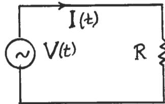
Για τάση  $V = V_0 \cos \omega t$  το ρεύμα στην αντίσταση είναι  $I = \frac{V_0}{R} \cos \omega t$ .
