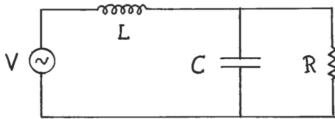
2.3 Στο κύκλωμα του σχήματος, η εφαρμοζόμενη τάση είναι  $V = V_0 \cos \omega t$ .
