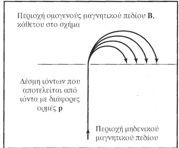
Σχ. 3.10 Το μαγνητικό πεδίο ως επιλογέας ορμής ( p ). Μια δέσμη ιόντων περνά από μια περιοχή με μηδενικό μαγνητικό πεδίο σε μια άλλη περιοχή με ομοιόμορφο μαγνητικό πεδίο B κάθετο στο επίπεδο της σελίδας.
